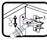
Если необходимо отрегулировать створку по высоте, нужно ослабить винт 3, отрегулировать створку в направлении С-С, а затем затянуть винт 3.
